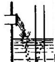
Schéma 6(b) Schéma. 6(b) La chaîne d'approvisionnement doit plonger en profondeur dans le puisard pour éviter les remous d'air dans l'eau
