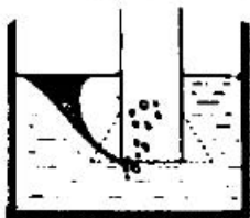
Schéma. 5 Agrandir la canalisation d'aspiration empêche généralement les tourbillons et que de l'air n'entre dans la tuyauterie.
